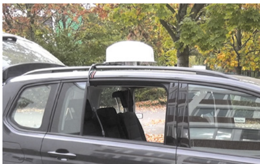
Figure 6 : ADFA Montée avec une sangle de sécurité et un câble RF acheminé.
