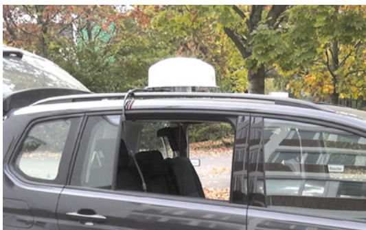
图 6: 用安全扎带装好的 ADFA 和布好的 RF 电缆
