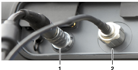
Figure 3: Connexion de câble RF : Connexion de commande (1) et connexion N (2)
