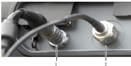
图 3： 连接 RF 电缆：控制接口 (1) 和 N 接口 (2)
