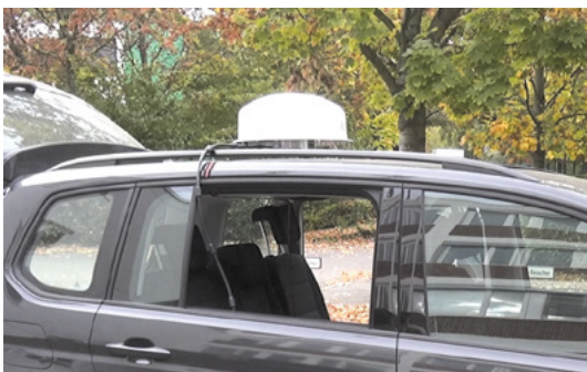
Abb. 6: Montierte ADFA mit Sicherheitsriemen und verlegtem HF-Kabel.
