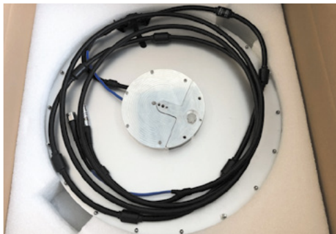
Abb. 1: Verpackung mit einer ADFA und einem bereits angeschlossenen HF-Kabel.
