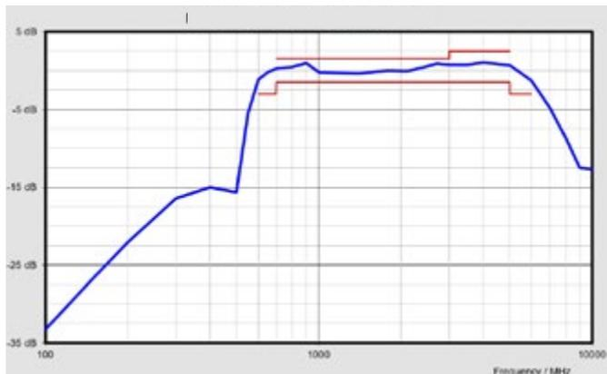
Abb. 1. Typischer Außerband-Frequenzgang EFD-0692
