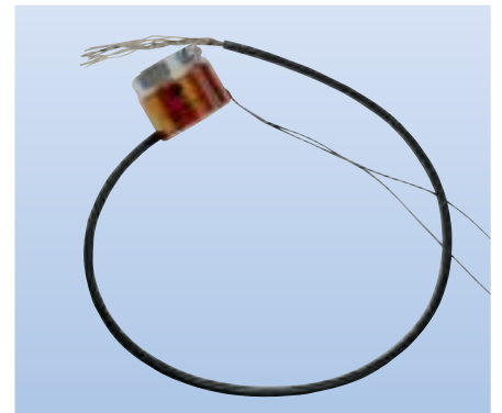
Temperaturbereichserweiterung eines Decoders von -15 °C auf nun -46 °C
