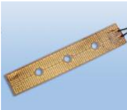
Kundenspezifische Kaptonheizfolie mit ausgesparten Löchern. Anschlusslitzen sind angeschweißt und zwischen den Kaptonschichten einlaminiert
