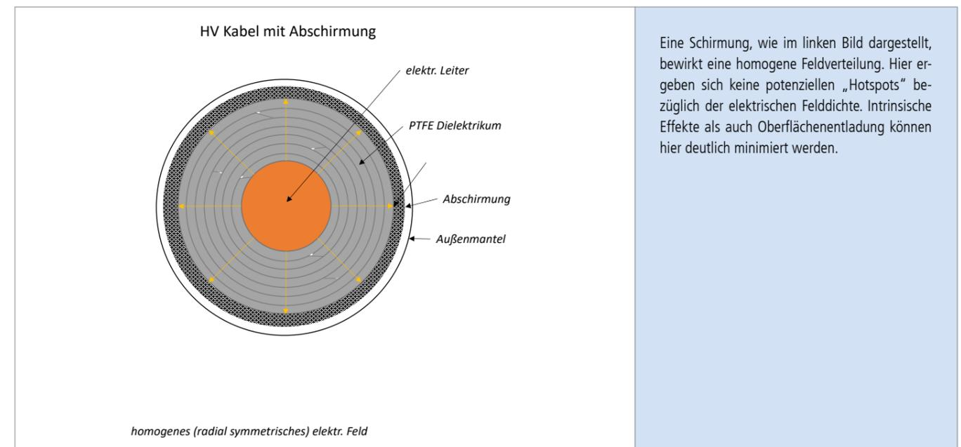
Eine Schirmung, wie im linken Bild dargestellt, bewirkt eine homogene Feldverteilung. Hier ergeben sich keine potenziellen „Hotspots“ bezüglich der elektrischen Felddichte. Intrinsische Effekte als auch Oberflächenentladung können hier deutlich minimiert werden.
