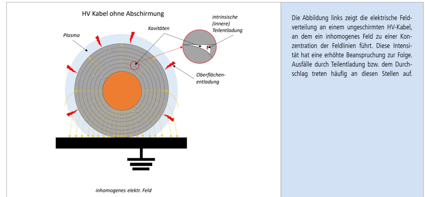
Die Abbildung links zeigt die elektrische Feldverteilung an einem ungeschirmten HV-Kabel, an dem ein inhomogenes Feld zu einer Konzentration der Feldlinien führt. Diese Intensität hat eine erhöhte Beanspruchung zur Folge. Ausfälle durch Teilentladung bzw. dem Durchschlag treten häufig an diesen Stellen auf.
