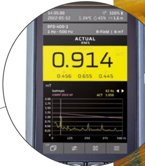
Beim Schweißen treten in der unmittelbaren Umgebung hohe impulsförmige magnetische Felder auf. Mithilfe der Narda H-Feld-Sonden lassen sich diese präzise nachweisen und bewerten.
