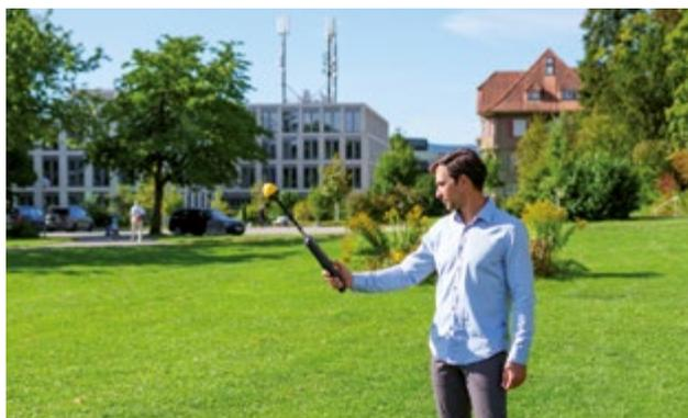
→ Der Ultraschall-Entfernungsmesser misst exakt die Messhöhe, in der der FieldMan betrieben wird. Und das bei einem Erfassungswinkel von 15 Grad im Bereich von 25 cm bis zu 400 cm auf den Zentimeter genau. Als Maßeinheit kann dabei m, in, ft oder yd gewählt werden. Ein separates Messen mit dem Meterstab entfällt.
