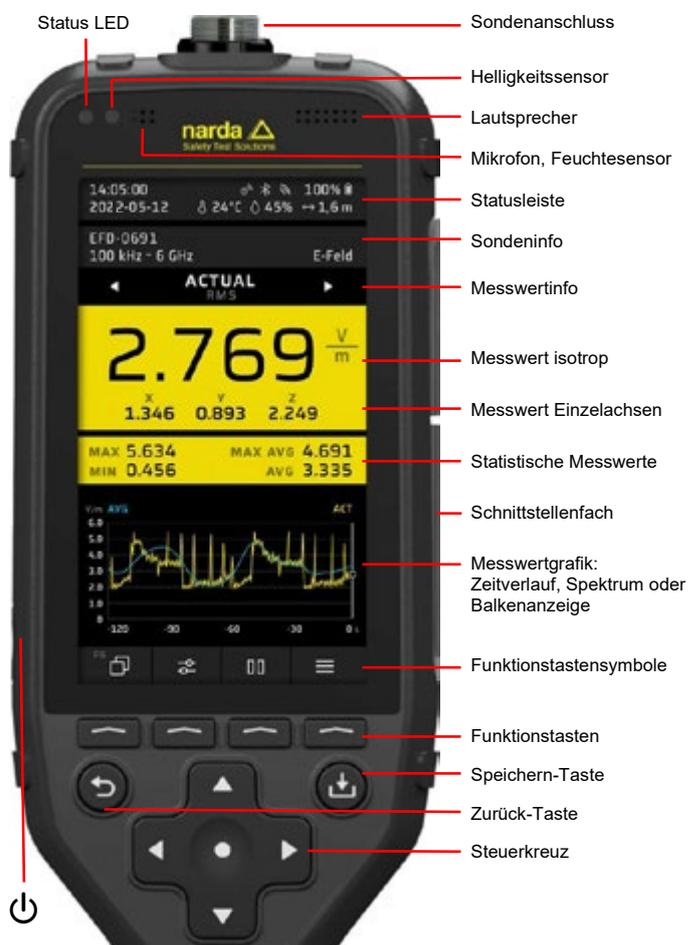
Abb. 2. Anzeige und Bedienelemente des FieldMan
