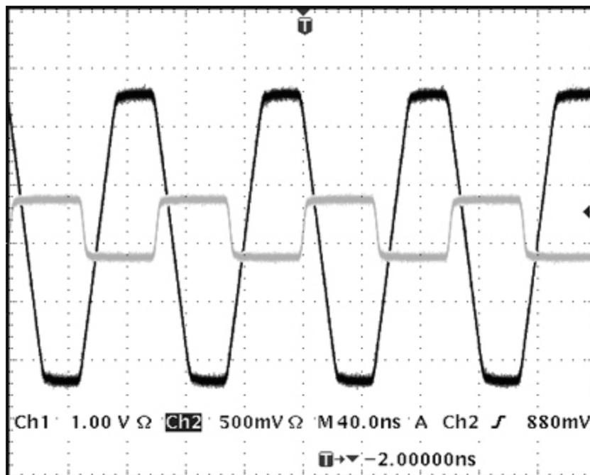
Die Wellenform wird mit einer anderen Amplitude und Offset und einer definierten Flankengeschwindigkeit neu erstellt.
