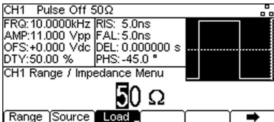
Beachten Sie, dass die Standard-Lastimpedanz 50 Ohm beträgt, jedoch auf jede Impedanz zwischen 50 und 10.000 Ohm eingestellt werden kann. Die Pegel werden auf der Grundlage dieser Impedanz berechnet.
