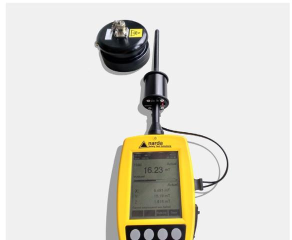
**Bild 4: Messung an einem Permanentmagnet mit Bedienung über das Messgerät NBM-550**
