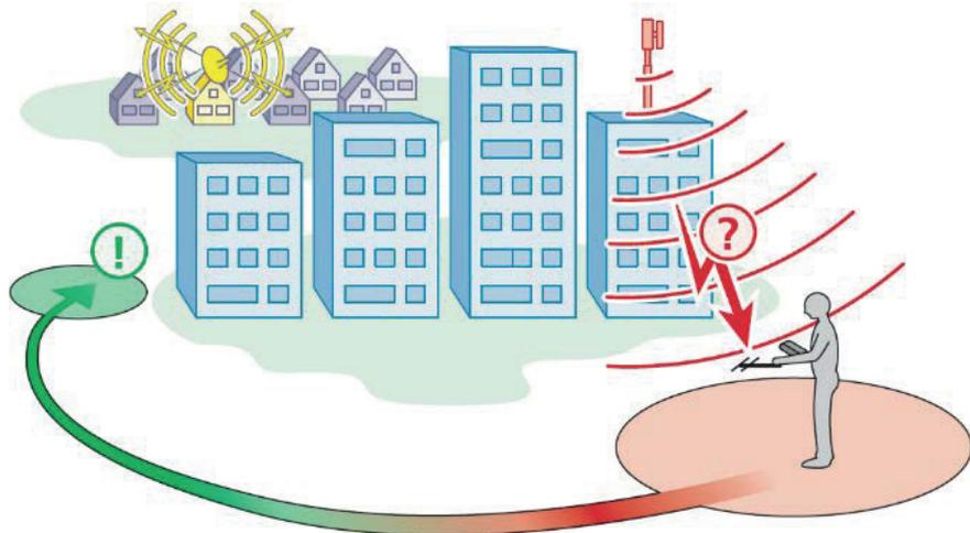
**Bild 11: Änderung des Messstandortes zur Vermeidung starker Downlink-Signale**
