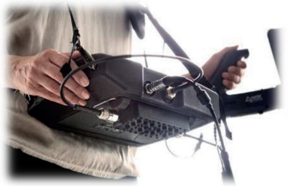
**Bild 10: Externe Filter zwischen Antenne und Empfänger**
