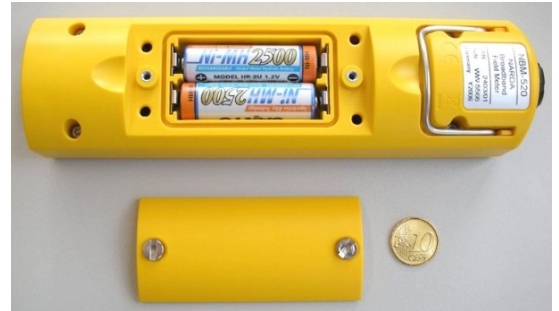
Das Batteriefach lässt sich einfach mit einer Münze öffnen. Das Gerät wird von zwei austauschbaren NiMH-Akkus Typ "AA" versorgt.
