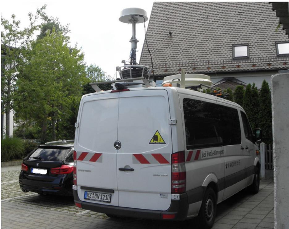
Bild 4-2: MKW mit R&S DDF550 und ADFA2-Antennen
