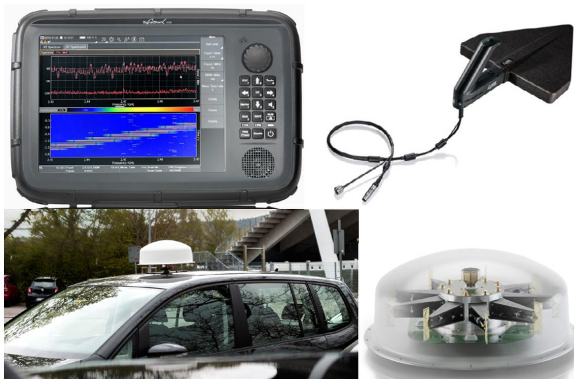
Bild 2-1: SignalShark Analysator mit Handpeilantenne (oben) und automatischer Peilantenne ADFA2 (unten)
