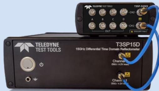
Das T3SP15D von Teledyne Test Tools stimuliert den Prüfling mit echten Differenzsignalen. Mit ihren kleinen Formfaktoren, dem geringen Gewicht und den optionalen internen Batterien können die Geräte überall im Testlabor oder im Feld zu einem günstigen Preis eingesetzt werden.
