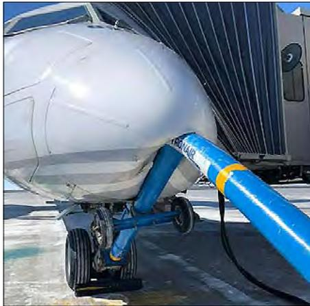
Das SiPsHitch™ Linear Force Monitoring System ist ein revolutionäres Flugsicherheitsprodukt, das Flugzeug-Pushback-Schleppern und Schlepptraktoren hinzugefügt werden kann, um den Bediener auf mögliche Überlastungssituationen aufmerksam zu machen. Als Teil der AERO-Produktreihe für Flugsicherheitsausrüstung kann das patentierte SiPsHitch™-System kostspielige Schäden an Flugzeugen, Schleppern und anderen Geräten verhindern.
