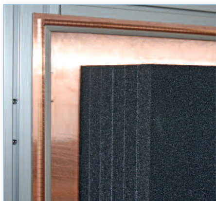
Detail dveří s těsněním a vícevrstvními absorbéry
