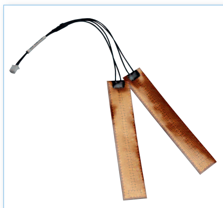
Fólie se zalitými přívodními vodiči a spol. konektorem
