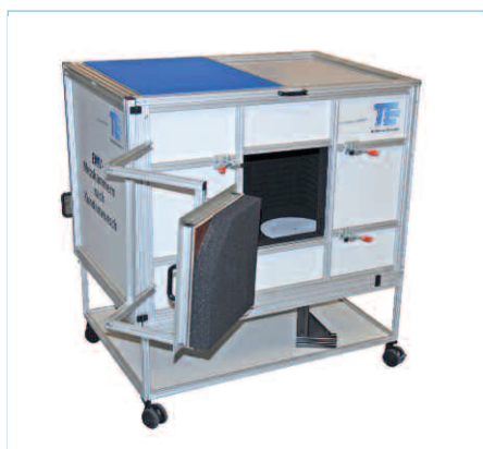
Měřicí tunel: propojení několika měřicích komor
