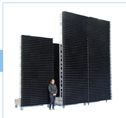
Pojízdné absorpční zástěny – vhodné např. pro testy radarové techniky
