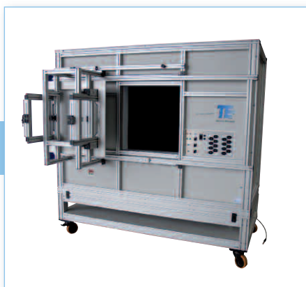
Mobilní komora s posuvnými dveřmi a použitými průchodkovými filtry
