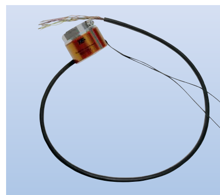
Montáž topné fólie na válcový kryt pro zvýšení teplotní odolnosti zařízení (použitelnost místo -15 °C až -46 °C)
