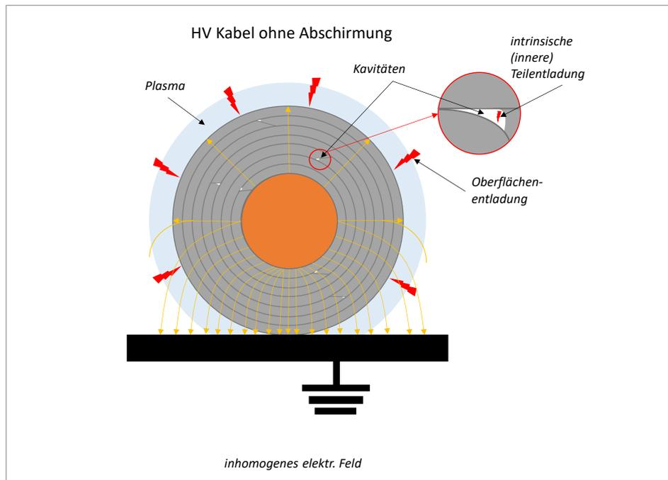
Die Abbildung links zeigt die elektrische Feldverteilung an einem ungeschirmten HV-Kabel, an dem ein inhomogenes Feld zu einer Konzentration der Feldlinien führt. Diese Intensität hat eine erhöhte Beanspruchung zur Folge. Ausfälle durch Teilentladung bzw. dem Durchschlag treten häufig an diesen Stellen auf.
