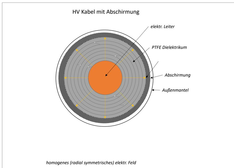
Eine Schirmung, wie im linken Bild dargestellt, bewirkt eine homogene Feldverteilung. Hier ergeben sich keine potenziellen „Hotspots“ bezüglich der elektrischen Felddichte. Intrinsische Effekte als auch Oberflächenentladung können hier deutlich minimiert werden.
